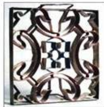
Motlle de mosaic hidràulic: Jordi Grisè/ Extracció llibre "El arte del mosaico hidráulico".
